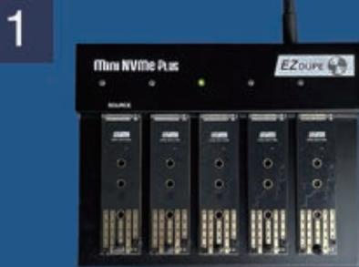
將電源接上後，機器將自動開機，當LED指示燈以跑馬燈方式閃爍綠燈時，即可開始進行操作。
